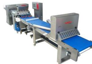
MESA MODULAR COMPRESSLINE DE 6/8 METROS MARCA AMBRO CON CARRO PORTA 6 CORTANTES, UN PALOTE, UNA MENSULA LATERAL, VELOCIDAD VARIABLE, UNA ESTACION DE CORTE A LA ENTRADA, PEDALERA DE COMANDO, TABLERO ELECTRICO P/ ACCESORIOS.
